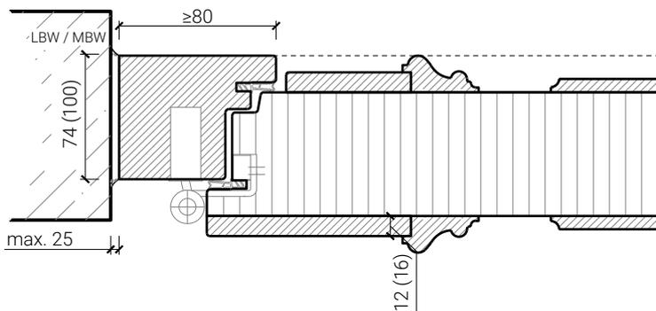
Mittelschlag 74 / 100 mm, Schlagleisten profiliert
