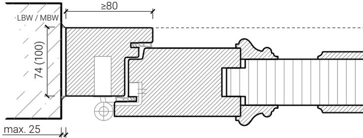
Mittelanschlag 74 / 100 mm, Schlagleisten profiliert
